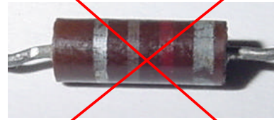
Incorrecto: el anillo plateado está colocado a nuestra izquierda.
